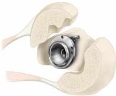
C Align Fin to Bicipital Groove
